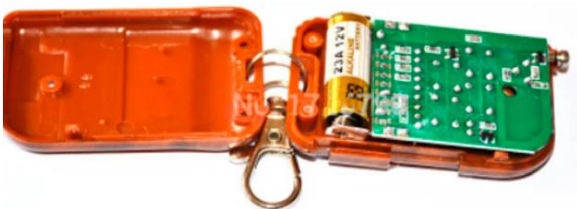
Após a inserção da bateria, parafuse a carcaça e o controle estará pronto para uso.
