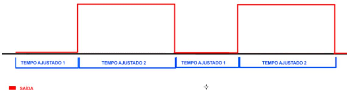
O modo P-3 precisa ser ajustado como o P-2, onde ajusta dois parâmetros para tempo, onde o primeiro é o de atraso e o segundo é o de acionamento, mas esse modo é cíclico isso é, ele faz o atraso no acionamento, aciona por um determinado tempo, volta para o atraso no acionamento, aciona por um determinado tempo, e faz esse loop infinito.
