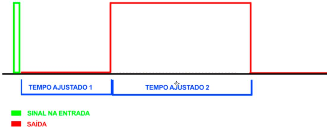
No modo P-2, ao receber um pulso a saída não é acionada instantaneamente, ocorre um atraso configurável para o acionamento do relé e um tempo determinado de acionamento antes de voltar ao repouso. Para isso são configurados 2 tempos: um para o atraso da saída e outro para o tempo de acionamento.
