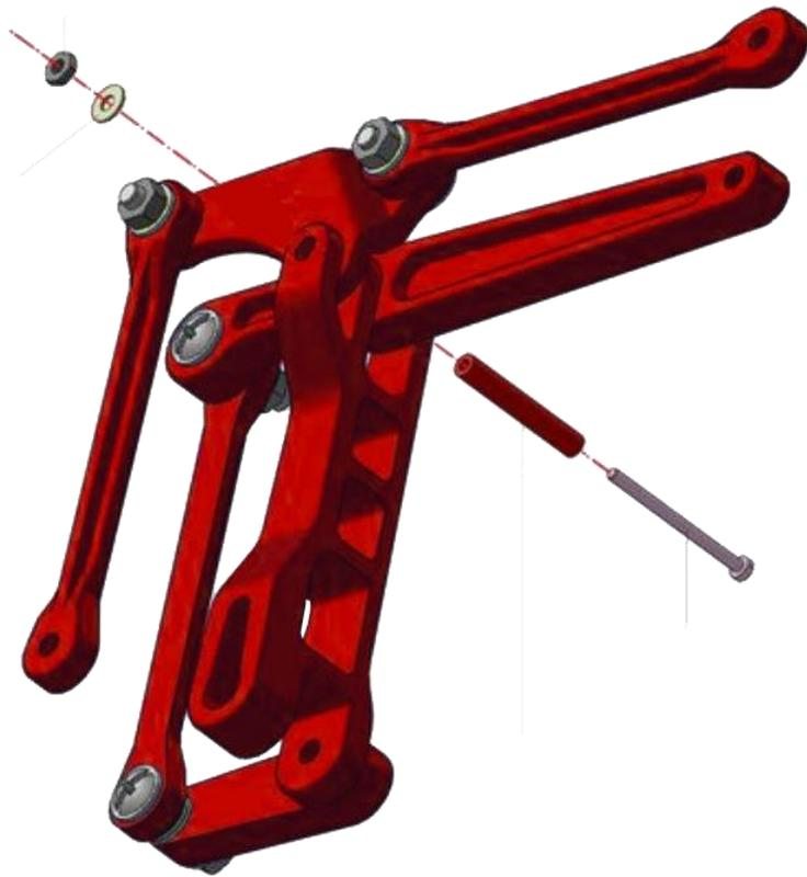
Junte as partes montadas anteriormente com o elo central do robô.
