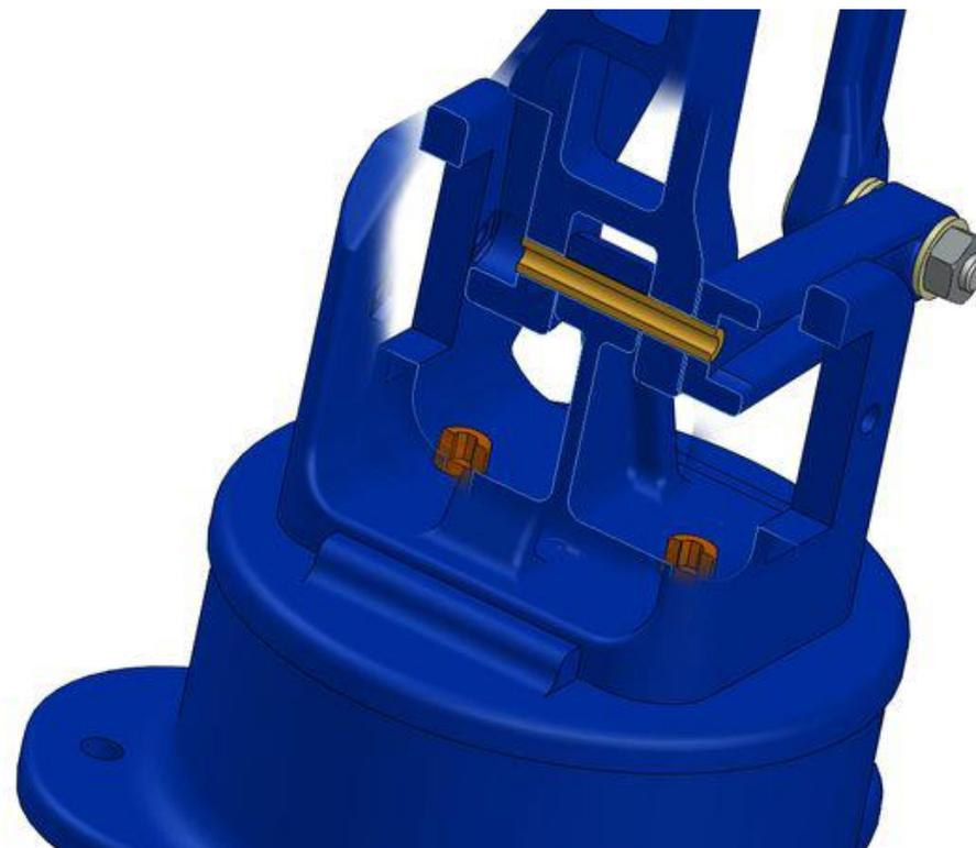
Coloque a haste metálica de 24mm
