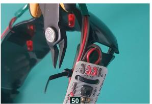
48 Você vai reparar que o fio é mais comprido que o necessário. Dobre o excesso de fio por baixo da PCI, posicionando-a no braço direito dos óculos. (Feche o braço para ter o máximo comprimento necessário).
